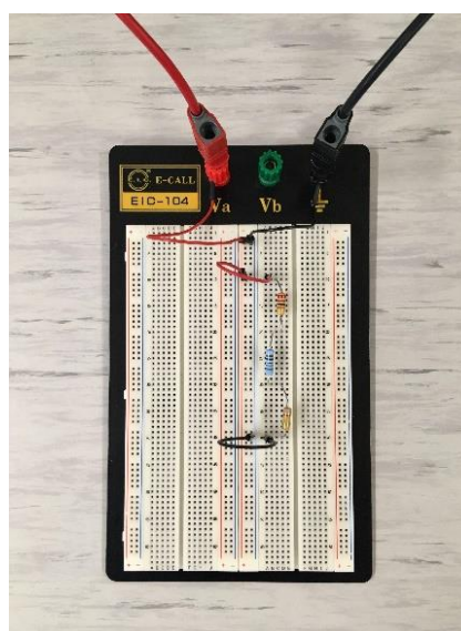
Slika 4.3: Serijski električni krug na protopločici
