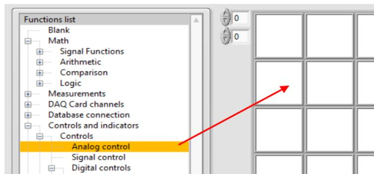
Figure 5.1: Setting the <Analog control> function - control
