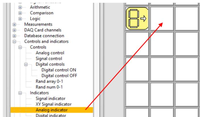
Figure 5.4 Setting a <Analog indicator> indicator
